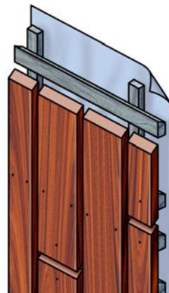
Tekening 4 Verticale open gevelbekleding op dubbel regelwerk.
